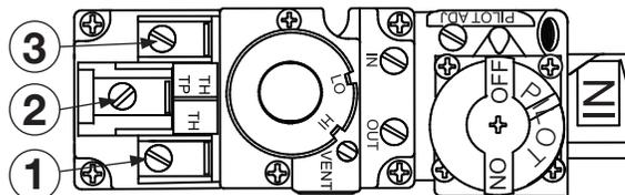
Déconnectez les fils des bornes 1 et 3 du soupape (de l'interrupteur marche/arrêt) et remplacez-les par les fils de l'interrupteur mural/thermostat millivolt.
