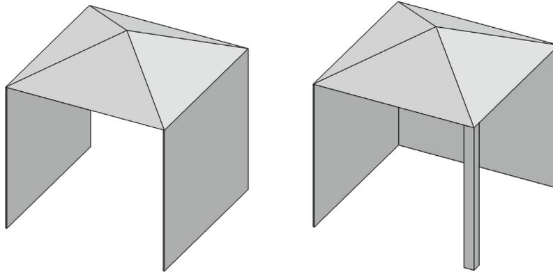
Installation à l'intérieur d'une enceinte partielle qui comprend un recouvrement sur les dessus et trois murs latéraux, dans la mesure où 30 pour cent ou plus de la périphérie horizontale de l'enceinte est ouverte en permanence.
