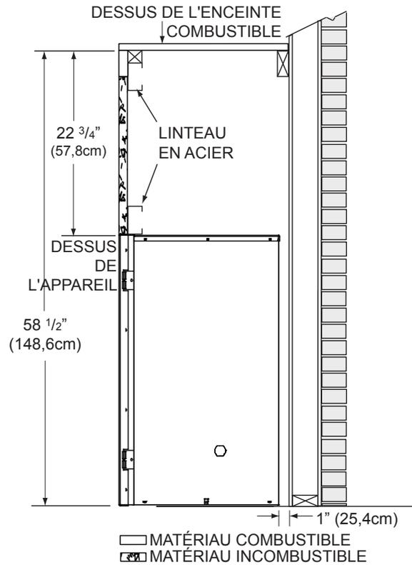
L'enceinte de l'appareil doit avoir une hauteur minimale de 58 1/2" (148,6cm).
