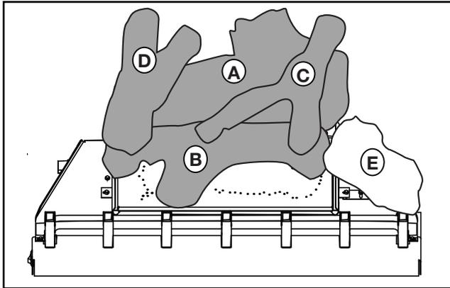
**E.** Placez la fente dans le bas de la bûche droite (W135-0670) sur le support à droite du brûleur, le côté carbonisé vers l'avant.
