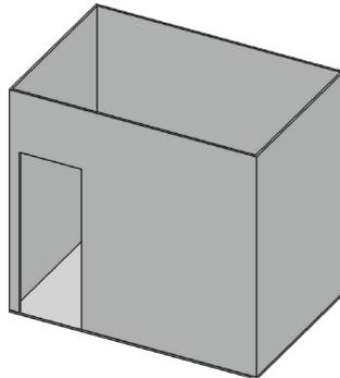
Installation à l'intérieur d'une enceinte partielle qui comprend un recouvrement sur le dessus et deux murs latéraux au maximum. Ces murs peuvent être parallèles l'un par rapport à l'autre, comme dans un passage couvert, ou former un anle droit.
