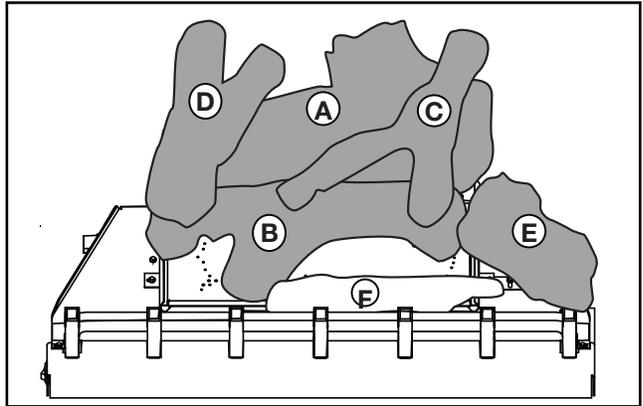
**F.** Placez la bûche F (W135-0481) en avant des orifices du brûleur, laissez-la reposer contre l'arrière de l'ensemble grille.
